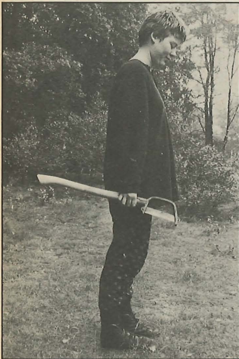
Slaggereedschappen tijdens vervoer in het zwaartepunt vasthouden
